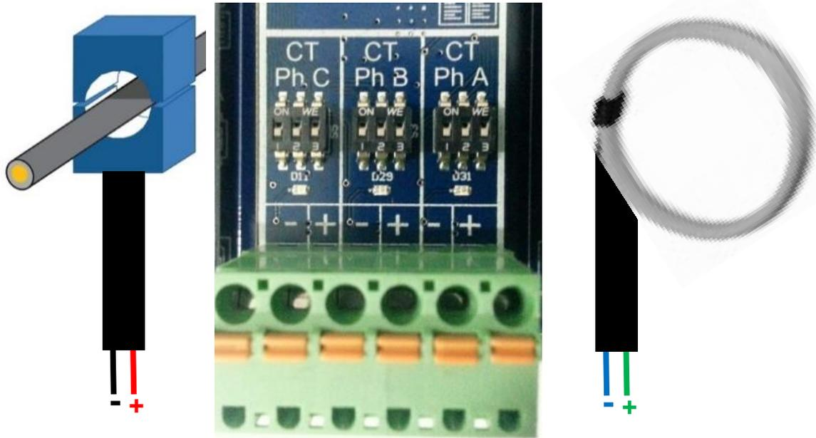
**3 – L'adéquation entre le courant mesuré, et la tension mesurée.** La valeur de puissance transmise par l'MM\_ENERGY36 sera construite par calcul entre la tension mesurée et le courant mesurée. A titre d'exemple, il faut impérativement que le courant mesuré par un tore câblé sur le CT PhA soit associé à la tension mesurée par la phase PhA. De même il faut associer les tores câblés en CT PhB, ou en CT PhC, avec les tensions mesurées par en PhB, ou en PhC.
