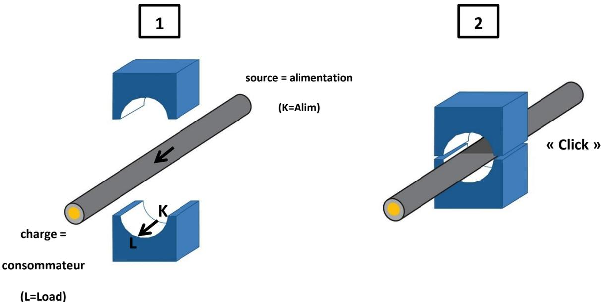
**IMPORTANT :** Pour ne pas générer d'erreur sur les données mesurées par l'MM\_ENERGY36, il faut que **l'installateur vérifie impérativement le sens des tores.**
