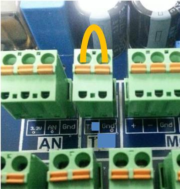
Pour configurer un MM\_ENERGY36 en « Répéteur », il faut insérer un shunt dans l'entrée T, entre le «GND» et «T». Le coordinateur interrogera alors ce « répéteur », pour savoir si ce répéteur voit des MM\_ENERGY36 qui ne sont pas vu directement par lui. Le « coordinateur » demandera alors au « répéteur » de lui répéter toutes les données que le « répéteur » aura reçu des « émetteurs indirectes » qu'il ne voit pas.
