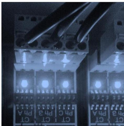
Pour la mesure sur un réseau triphasé, le système tentera de remettre automatiquement les phases dans l'ordre (dans la limite d'un cos PHI comprise entre plus ou moins 0.6). Dans le cas où le cos PHI est au delà de la plage +/-0.6, le système ne sera peut-être pas en mesure de donner une indication correcte, et le clignotement des leds pourra être erroné.
