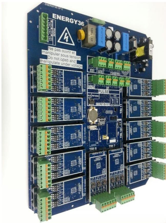
Le compteur multi-ligne MM\_ENERGY36 permet l'accès à de très nombreuses données mesurées sur votre réseau électrique. Il a été conçu pour le comptage énergétique. Il dispose de nombreuses capacités de communication, ainsi que d'un logiciel de visualisation et d'analyse de données. L'ensemble des données mesurées peut être exploité par de nombreux logiciels de management énergétique.
