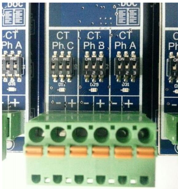
La configuration est à effectuer sur chaque carte de mesure suivant le tableau de configuration ci-dessous en fonction des différents types de tore utilisés :
